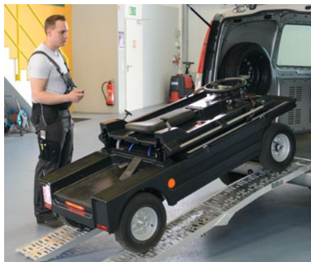
Verladung mittels Fernsteuerung
